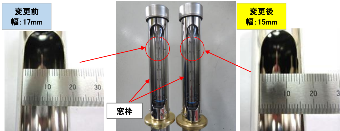
図1 油面温度計の窓枠形状変更
